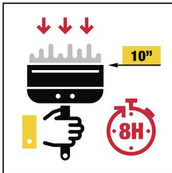
Segunda y tercera capa: Cuando el compuesto esté completamente seco, después de 8 horas aproximadamente, aplique la segunda capa con una espátula de 10" alisando la superficie.
