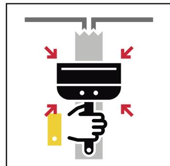
Coloque la cinta de refuerzo sobre la junta y presione con la espátula, quitando el exceso.
