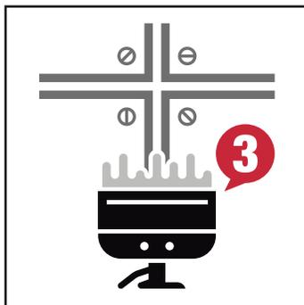
Las cabezas de tornillos, esquineros y accesorios deben ser cubiertos con tres capas de compuesto. Para más información revisar el manual GA-236.
