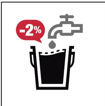
Solo en aplicación de cintas y acabado, puede agregar hasta el 2% de agua sobre el peso del producto. El exceso de agua puede causar agrietamientos o desprendimientos. Este producto contempla la norma ASTM C-475.
