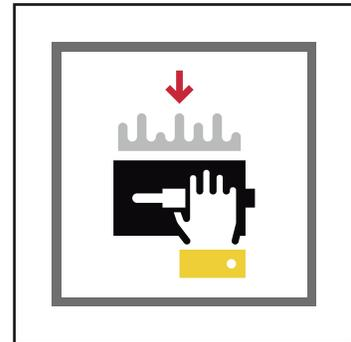
Con una llana metálica aplique una delgada capa de producto sobre el sustrato.
